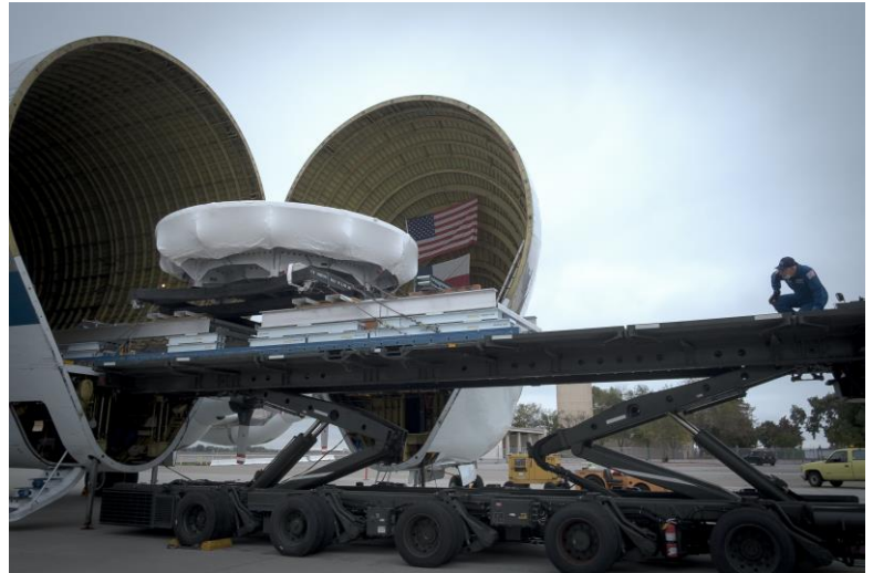
Afbeelding 1. Het hitteschild voor de Artemis IV Orion wordt uit de Aero Spacelines Super Guppy geladen op de K Loader op Moffett Federal Airfield. Bron Credits: NASA/Ames Research Center/Don Richey
